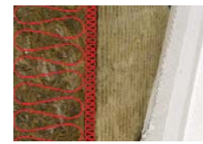
Vakolt homlokzati rendszerekben alkalmazott kétrétegű, inhomogén kőzetgyapot lemez
